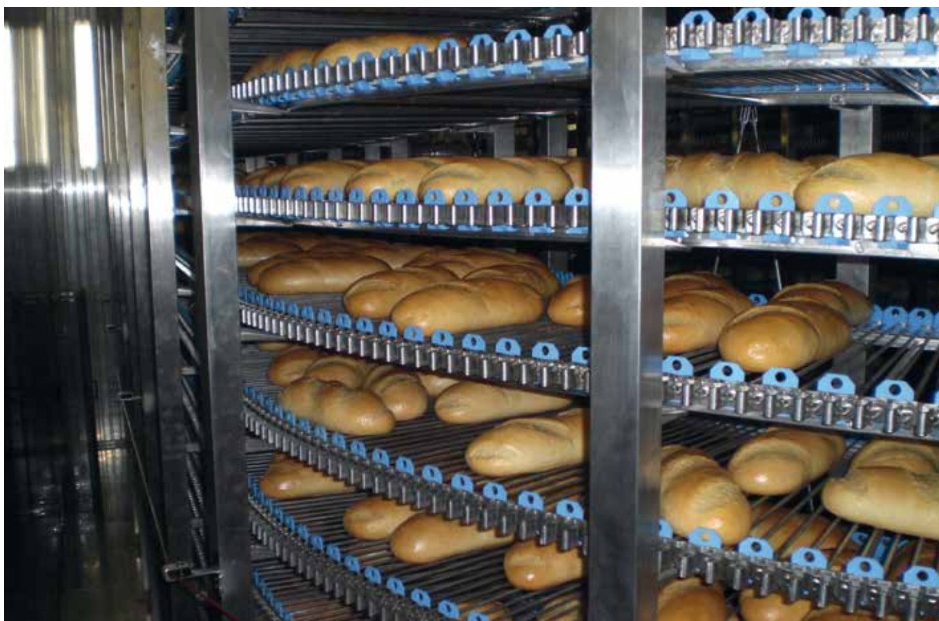
Raffreddamento forzato in cella
